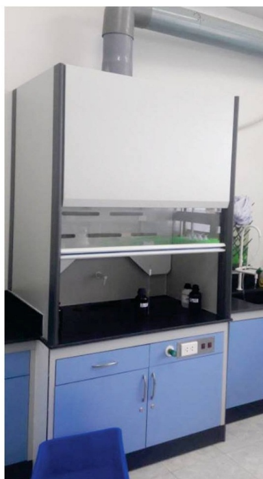
Tủ hút sử dụng vật liệu phenolic
